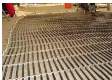
Figure 16 : Grille flexible pour maquereaux et harengs (source : SNG Ltd, (Laurenson and MacDonald 2008))
