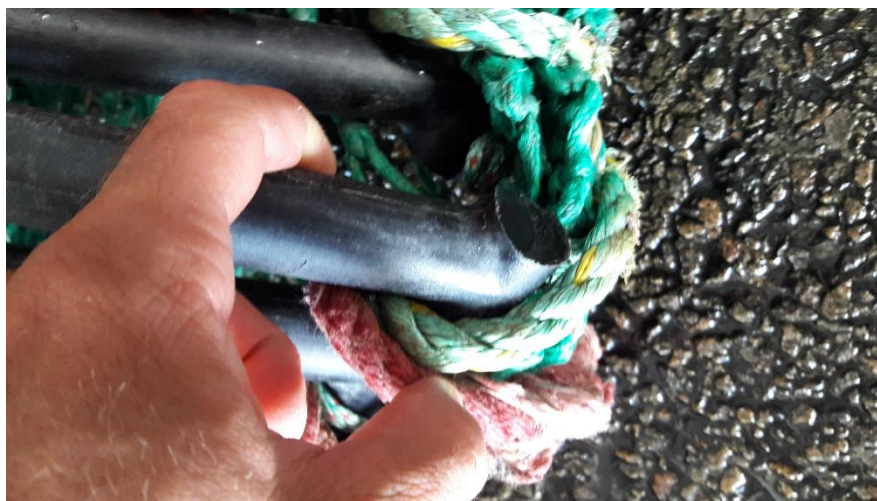
Figure 33 : Illustration d'une cassure en lien avec une bulle après 7 semaines d'utilisation (Source : AGLIA)
