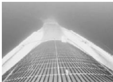
Figure 16 : Grille flexible pour maquereaux et harengs (source : SNG Ltd, (Laurenson and MacDonald 2008))
