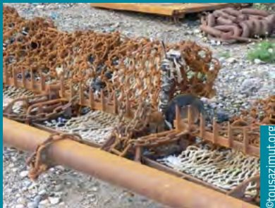
Dragues « à ressort » montées sur un bâton
