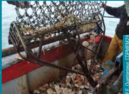
Drague à dents flexibles en baie de Saint-Brieuc
